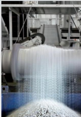
Der *microcor*® Basecoat ist ein silberfarbener Überzug, ein thermoreaktives System, hochgefüllt mit Zink- und Aluminiumlamellen. Dieser Überzug erzeugt den hohen Korrosionsschutz.
